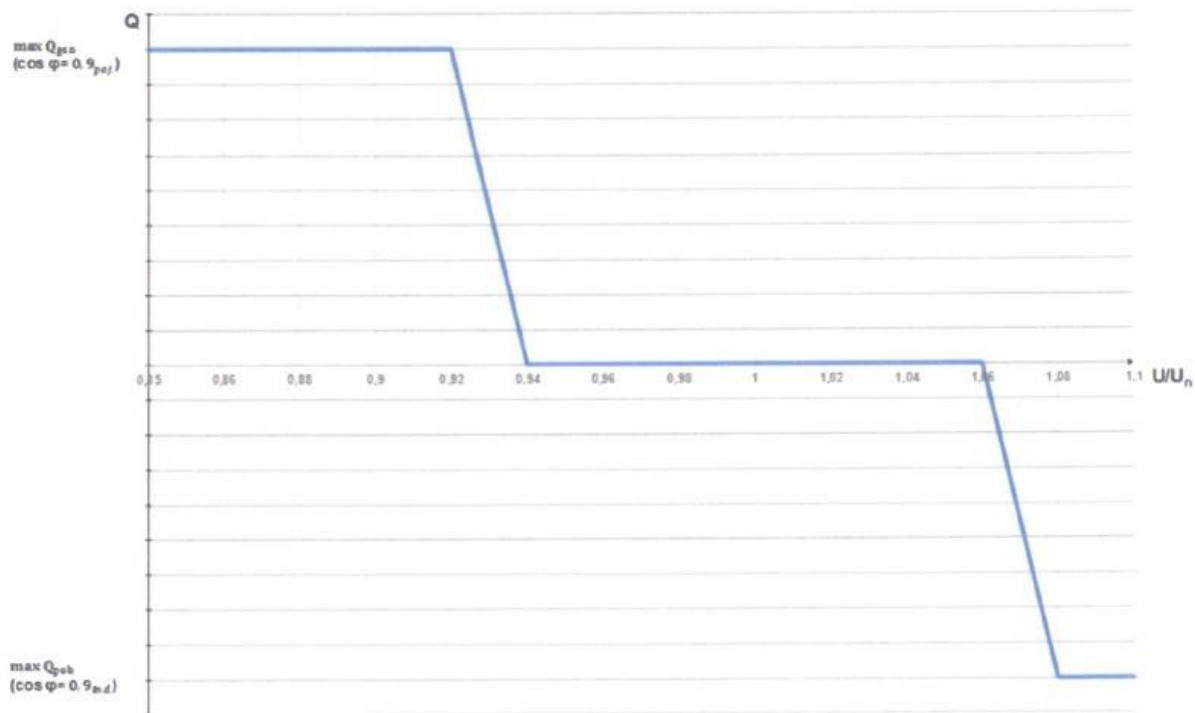
Rys.3. Charakterystyka sterowania mocą bierną w funkcji napięcia wymagana przez OSDn.
