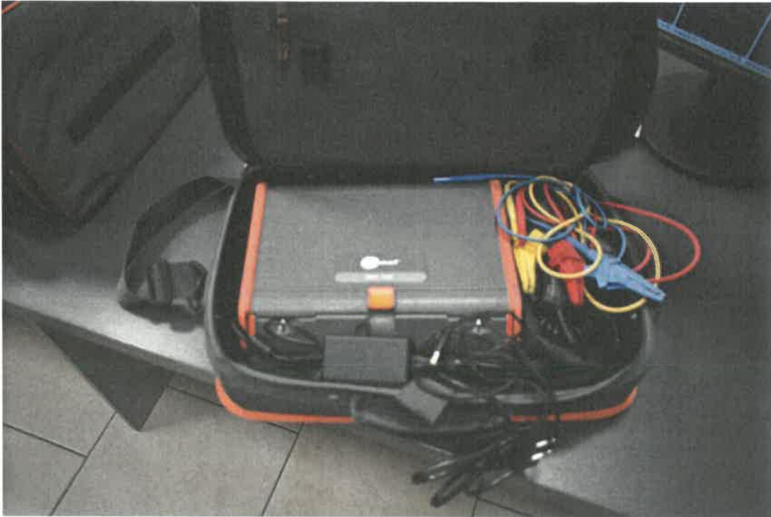
Zdjęcie 5. Miernik parametrów instalacji elektrycznych.
